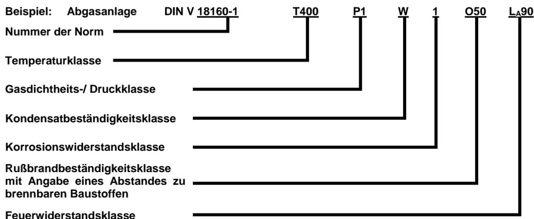
Jeder Zug der Abgasanlage muss gut sichtbar dauerhaft (z. B. Aluminium-Klebschild) mit einer vollständigen Anlagenkennzeichnung versehen werden. Mögliche Stellen für das Anbringen sind die Reinigungsverschlüsse (Türen) im Aufstellraum der Feuerstätte oder an der Stelle des Abgaseintritts in die Abgasanlage.
