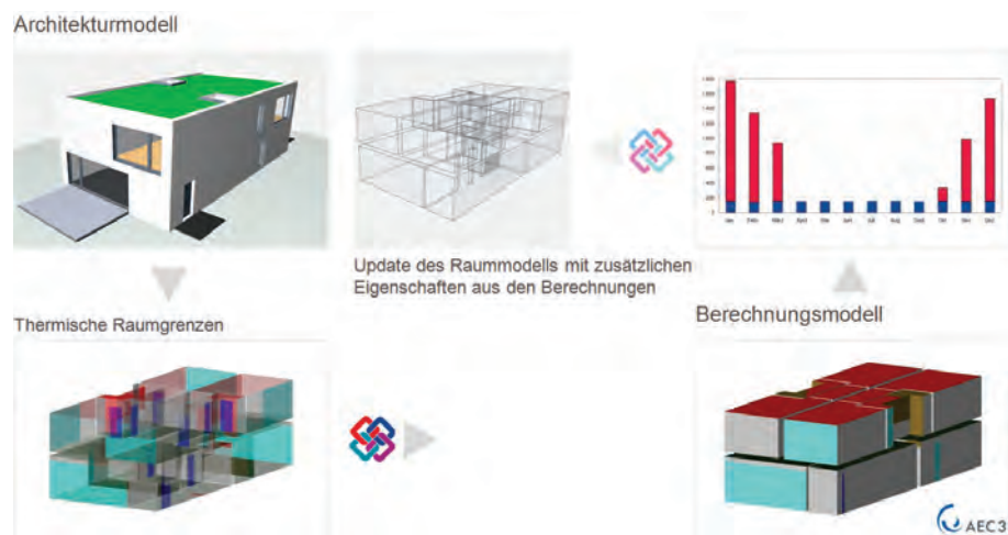
Abbildung 4.21: Übertragung der Ergebnisse der Berechnungen (Quelle: AEC3)
